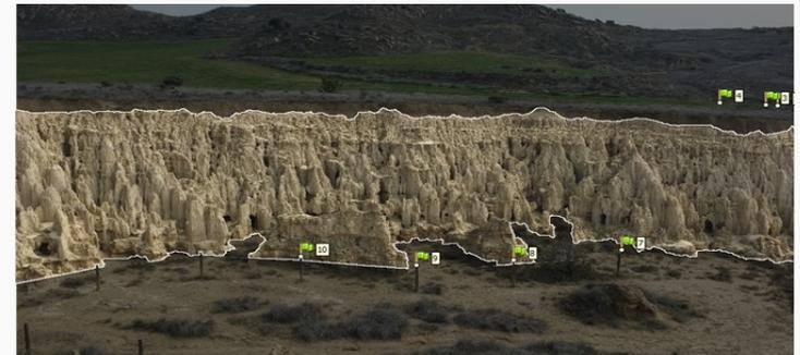
Imagen digital del área de estudio con máscara y puntos de control para el análisis fotogramétrico (Agisoft Photoscan)
