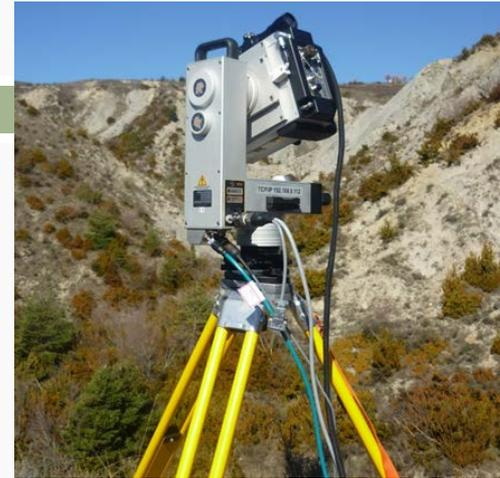
Escaner TLS: mide el tiempo entre la emisión de un pulso de luz y su detección de vuelta. El valor se multiplica por la velocidad de la luz a través del aire y se divide para dos
